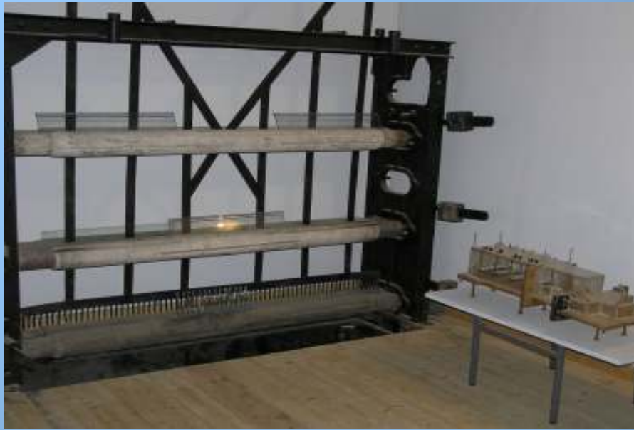
1928-1995 aastal Järvakandi klaasivabrikus kasutusel olnud tahvelklaasi vertikaalne tõmbemasin. Järvakandi Klaasimuuseumi eksponaat
